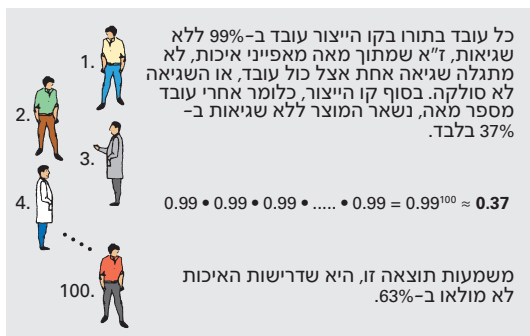
תמונה 2: הצטברות שיגאות בגין העברת חלקים פגומים בקו הייצור
