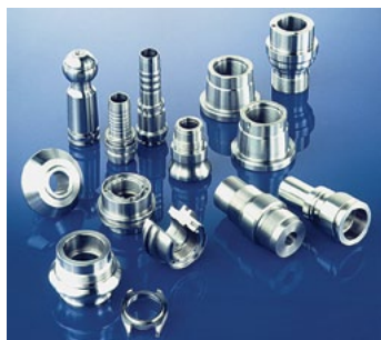
תמונה 2: חלקים חרוטים מפלדה קלת שיבוב
