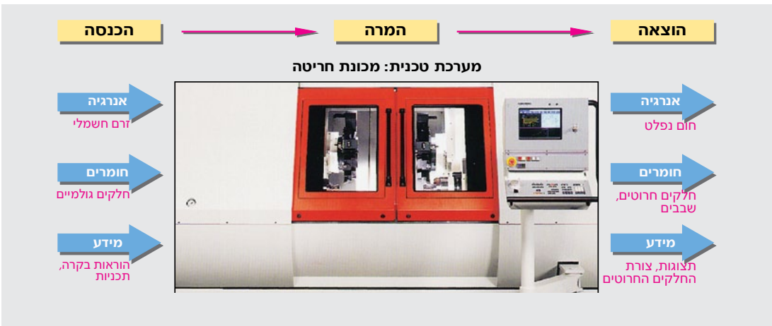
תמונה 1: המכונה כמערכת טכנית, על פי דוגמה של מכונת חריטה
