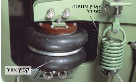
תמונה 1: קפיץ אוויר במכונת ייצור בד (טקסטיל)
