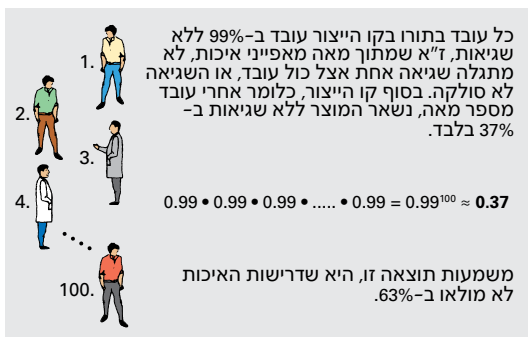
תמונה 2: הצטברות שגיאות בגין העברת חלקים גומים בקו הייצור
