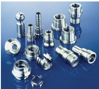
תמונה 2: חלקים חרוטים מפלדה קלת שיבוב
