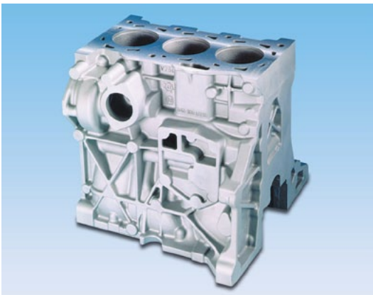
תמונה 3: גוף מנוע מסגסוגת יציקה- AlSi
